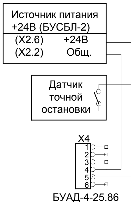
Рис.13. Откидывание замка при пропадании ~220В. Блок-схема подключения датчика точной остановки к БУАД без УЗВП-1. +24В подается от дополнительного источника питания. В точной остановке на X4.5 БУАД должно подаваться +24В.
